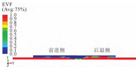
图 11 基板与增材层材料混合分布,红色代表原始基板材料,蓝色代表原始增材层材料
