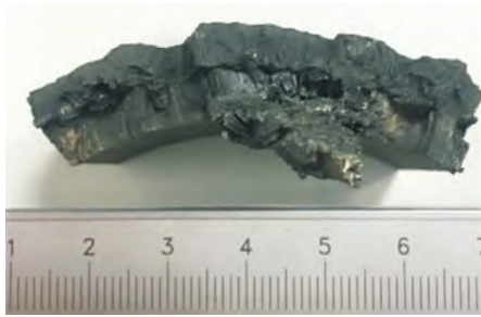
图3 裂纹1断口的宏观形貌
