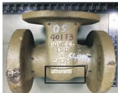
图 1 因严重的裂纹缺陷而报废的产品
