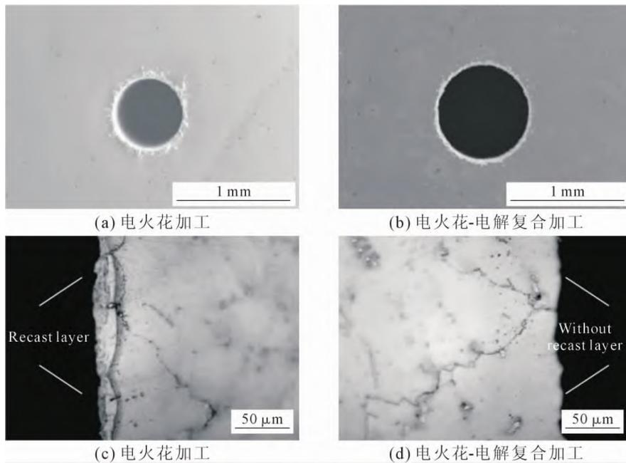
图 6 电火花加工和电火花-电解复合加工下的孔入口形貌和孔内壁重铸层金相图<sup>[38]</sup>
