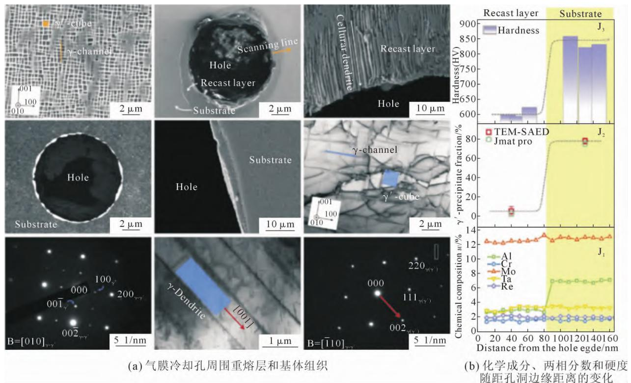
图5 气膜冷却孔周围重熔层和基体的微观结构及化学成分、两相分数和硬度随距孔洞边缘距离的变化<sup>[23]</sup>
