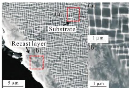
图 4 气膜冷却孔周围重熔层
