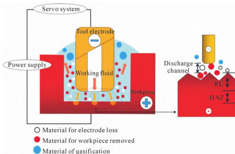
图 3 电火花加工原理及热损伤层的形成
