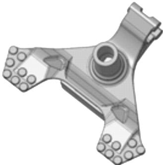
图3 重构的平衡轴支架结构图
