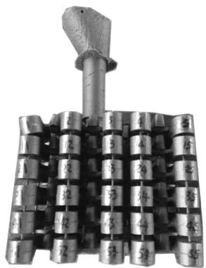
图6 带浇注系统的注塑机小铰链
