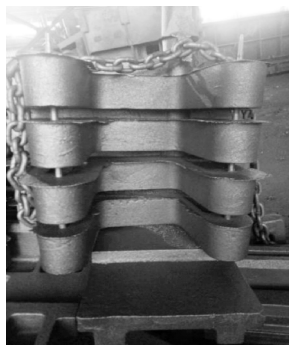
图7 注塑机导杆支架铸件
