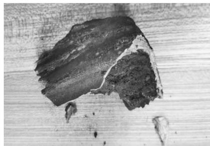
图6 使用保护渣1浇注时形成的渣条
