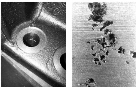
图6 铸件缩孔
