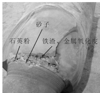
图 2 φ480×900 离心复合铸造高镍铬无限冷硬铸铁轧辊熔合不良缺陷位置
