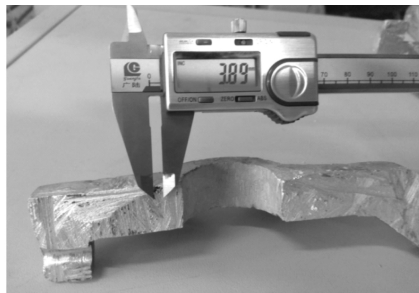
图3 B组方案生产的铸件,有一个小的缩孔缺陷
