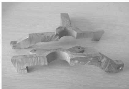
图4 B组设计方案改进后生产的铸件,消除了缩孔缺陷
