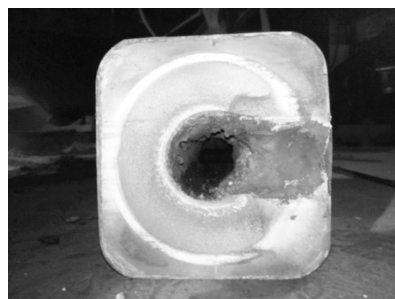
图 1 使用 6.5 h 后的浸入式水口板面
