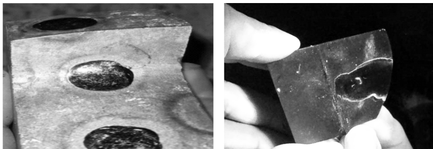
图4 熔模精密铸件焊接周边部位表面缺陷
