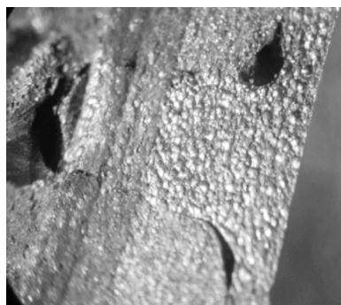
图4 芯撑熔合不良情况 Fig.4 Poor chaplet fusion
