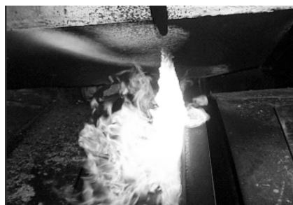
图4 小尺寸铸轮浇注时侧漏
