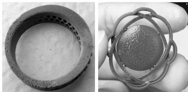
图5 蜡模砂孔缺陷
