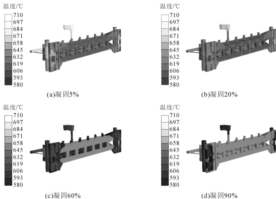
图4 铸件凝固过程温度场
