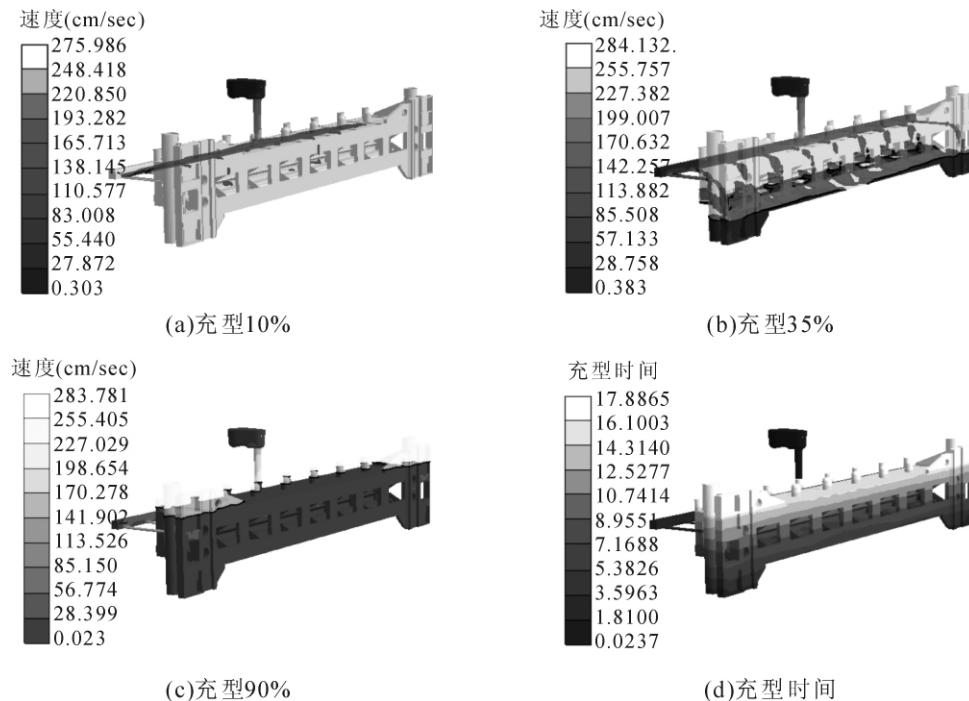
图3 铸件充型过程模拟结果
