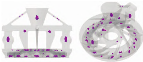
图 5 模拟的铸件缩松缩孔缺陷分布
