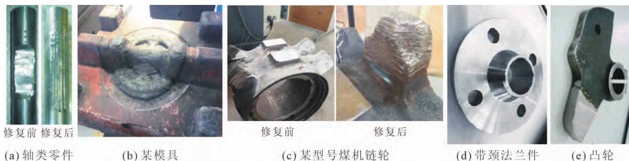
图 6 WAAM 修复或制造案例 [36-39]
