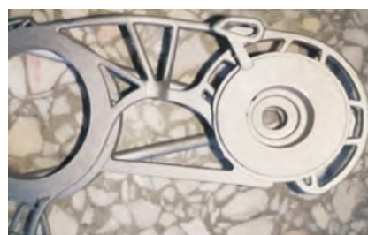
图6 采用带水溶蜡芯的蜡模铸造的铸件外观
