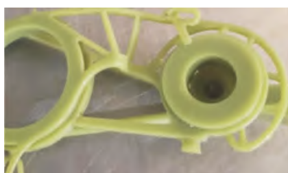
图5 水溶蜡芯去除后清洗干净的蜡模
