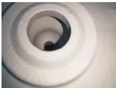
图 12 采用水溶芯蜡芯的蜡模铸造的铸件外表及内腔形貌
