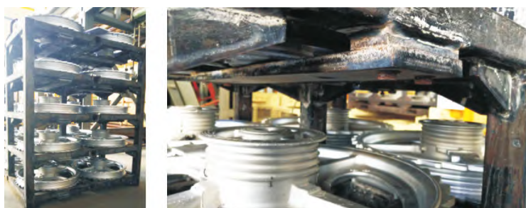
图2 新设计的热处理零件筐,右图为局部细节照片
