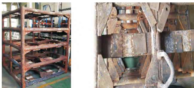
图1 原先的热处理零件筐,右图为局部细节俯视照片
