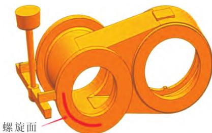
图 11 某铝合金吸阀体的浇注系统设计
