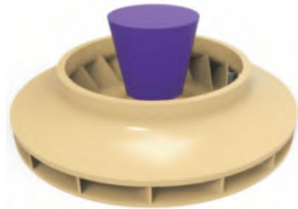
图 13 叶轮浇注系统设置
