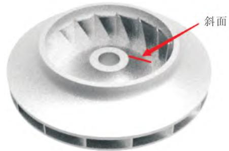
图 12 叶轮铸件
