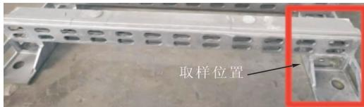
图 1 铸造铝合金箱梁及取样位置
