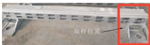
图 1 铸造铝合金箱梁及取样位置
